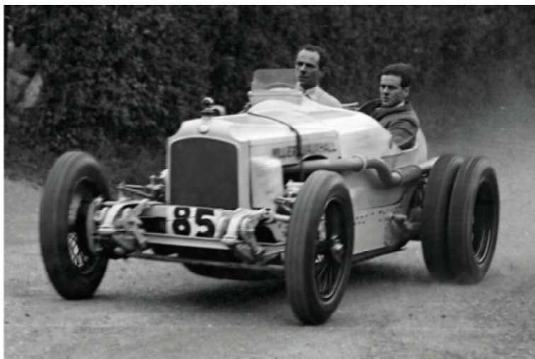
Villiers Vauxhall. La foto corresponde a la subida Shelsley Walsh de 1929. Raymond Mays al volante, acompañado de su mecánico Peter Berthon. Mays compró un viejo Vauxhall TT de 1922 y se lo envió a Amherst Villiers para que le acoplara un compresor Rootes a su 4 cilindros de 3 l con doble árbol de levas en culata y 4 válvulas por cilindro. Fue uno de los pioneros en montar ruedas traseras gemelas para mejorar la motricidad, anterior al Auto Union tipo C.
